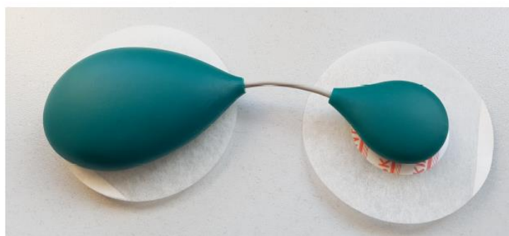
Slika 7. Izgled Savvy uređaja za bežično mjerenje EKG-a. Preuzeto i obrađeno iz (54).
