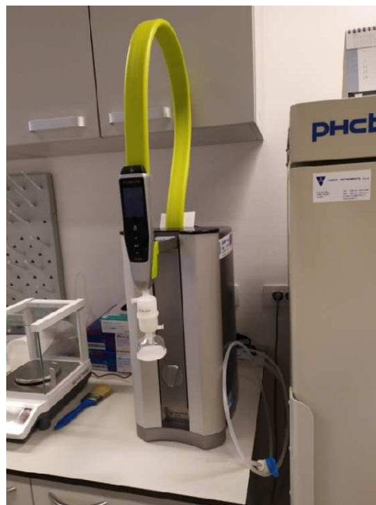
Slika 2. Uređaj za pročišćavanje vode (Purelab Flex 3 (18.2 M \Omega , UV 185/254 nm, TOC <5 ppb, Tip 1), Elga)
