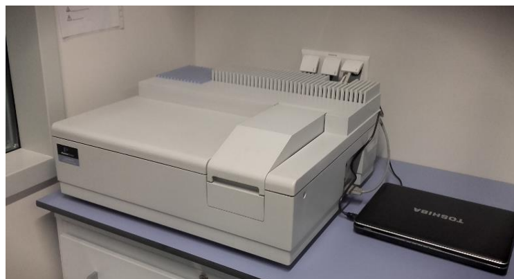
Slika 9. UV VIS spektrofotometar Perkin Elmer Lambda 25, double beam. (Izvor: privatna arhiva)
