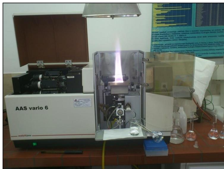
*Slika 7. Atomski apsorpcijski spektrofotometar AAS Vario 6, Analytik Jena.
