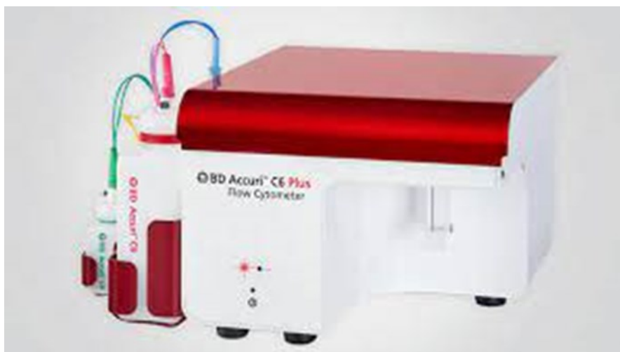
Slika 9. Protočni citometar na kojem je rađeno ispitivanje
