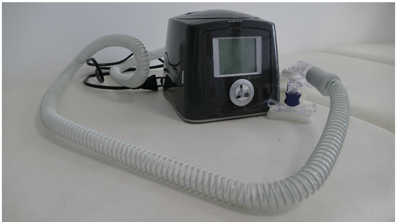
Slika 3. CPAP uređaj i pripadajuća nazalna maska spojena crijevom na uređaj
