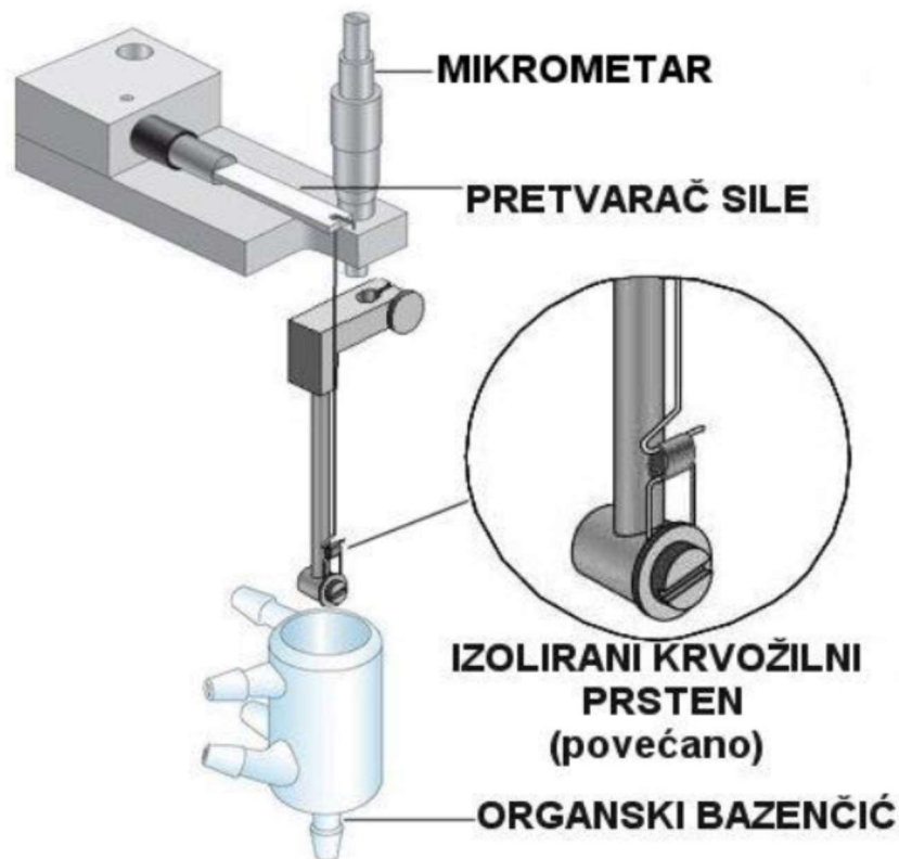
Slika 8. Shema sustava za mjerenje tonusa izoliranog krvožilnog prstena.
