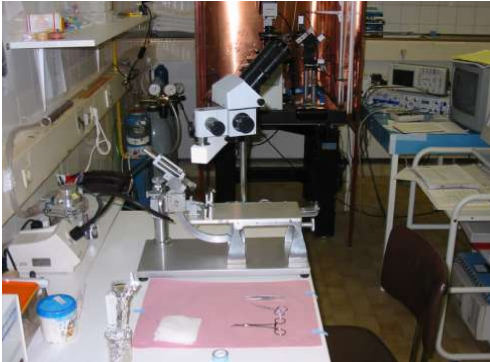
Slika 7. Izgled radne površine, stereotaksijski okvir i operacijski mikroskop – Laboratorij za histologiju Medicinskog fakulteta u Splitu.
