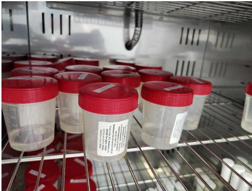
Slika 10. Uzorci pohranjeni u destiliranoj vodi
