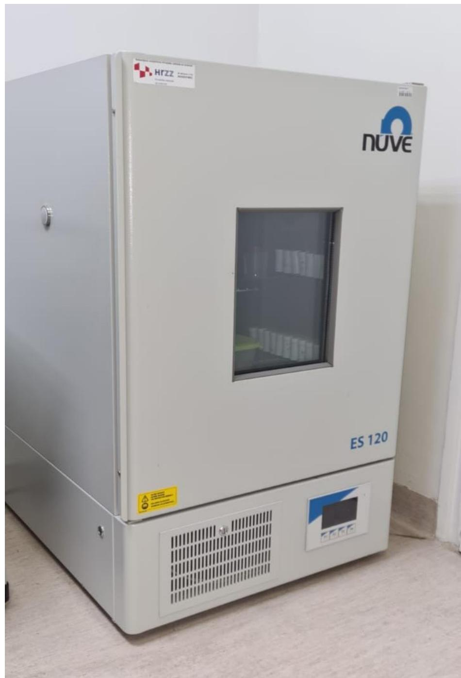
**Slika 9.** Inkubator za pohranu uzoraka
