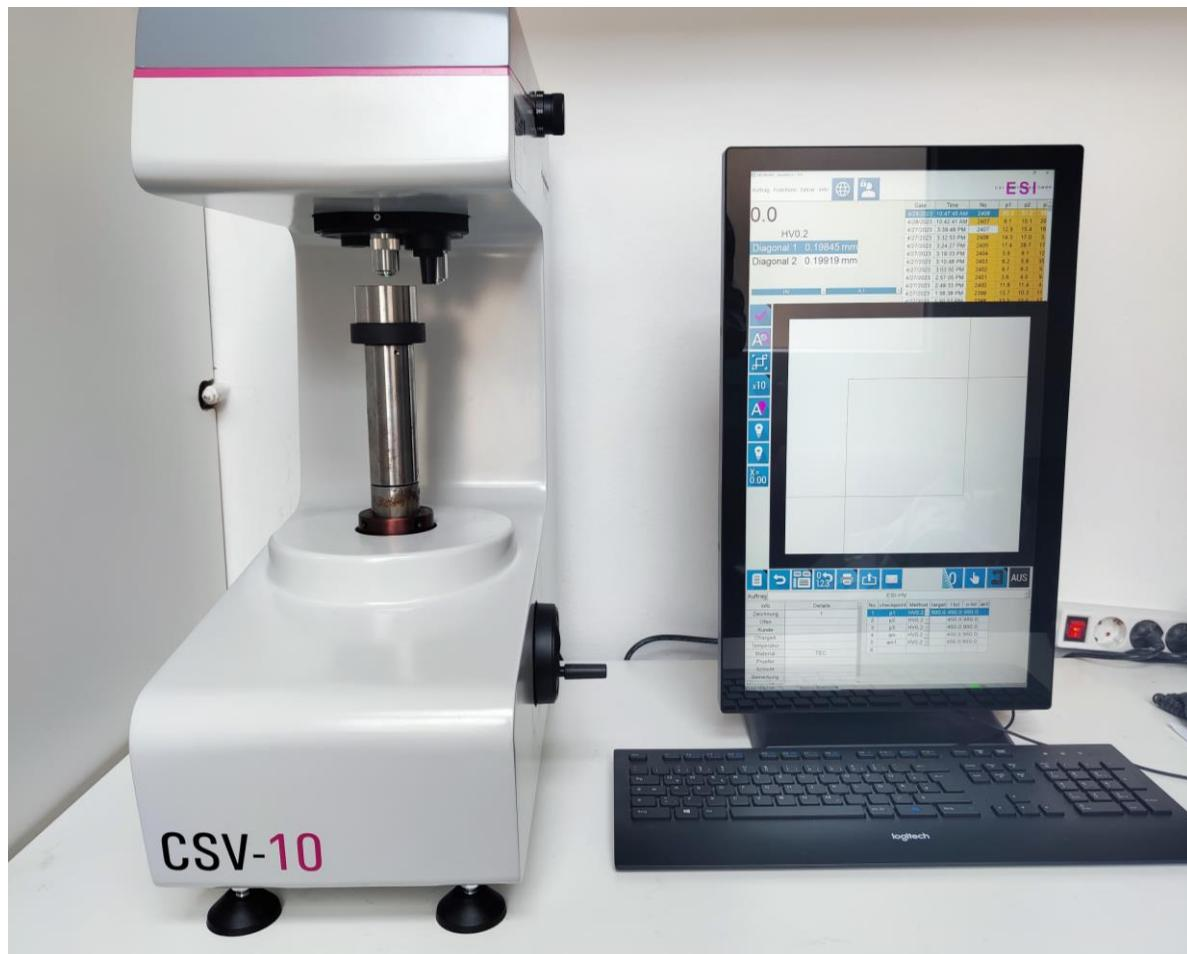
Slika 12. Mikrotvrdomjer CSV-10
