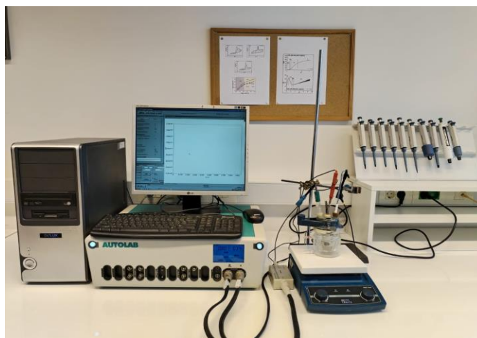
Slika 11. Uređaj Autolab PGSTAT 302N, spojen na računalo i troelektrodna ćelija.
