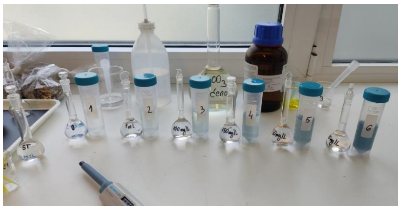
Slika 14. Priprema otopina galne kiseline za izradu krivulje umjeravanja.
