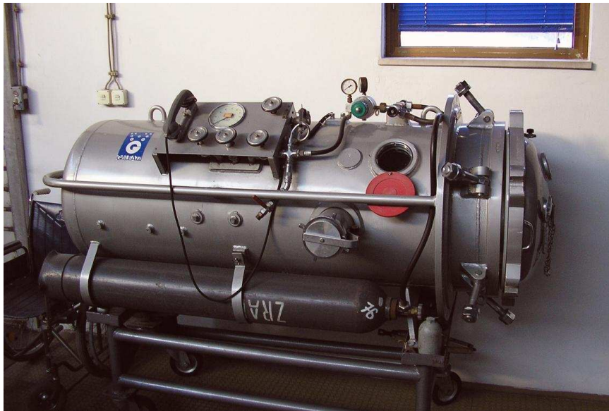
Slika 7. Jednodijelna rekompresijska barokomora
