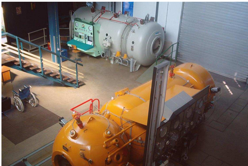
Slika 6. Višedijelne rekompresijske barokomore u IPM HRM u Splitu
