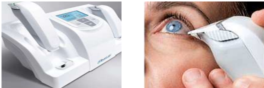
Slika 11. Osmometar i način mjerenja osmolarnosti suza
