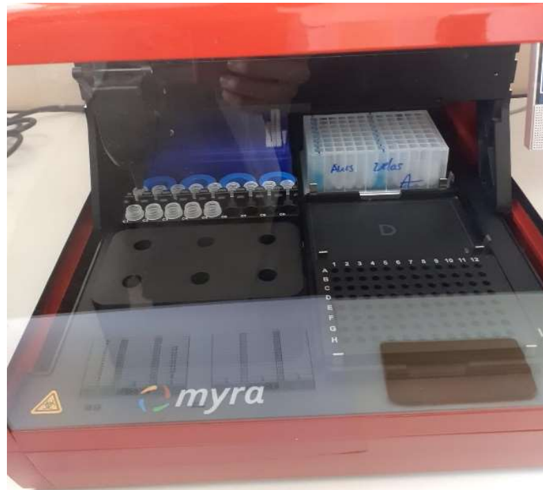
Slika 7. Automatizirani pipetor Myra s ubačenim izolatima u Laboratoriju za molekularnu dijagnostiku NZJZ – SDŽ
