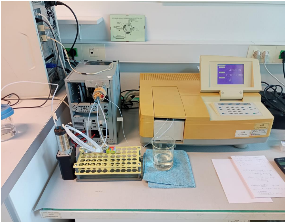
Slika 15. Laboratorijska oprema i SIA sustav za metodu određivanje PEN-a.
