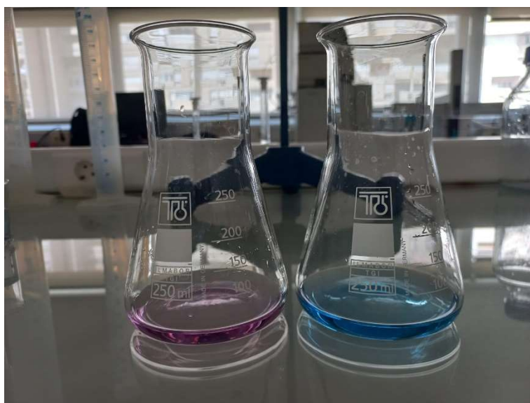
Slika 8. Boja otopine prije početka titracije (lijevo) i nakon promjene boje u završnoj točki titracije (desno)
