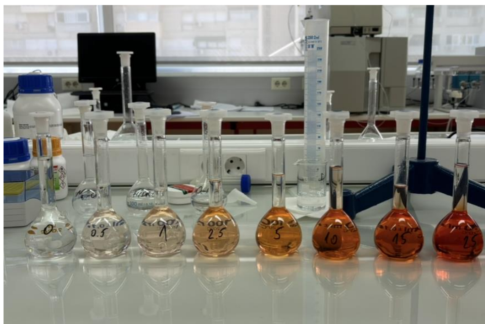
Slika 9. Standardne otopine željeza, s lijeve strane prema desnoj u koncentraciji 0; 0,1; 0,2; 0,5; 1; 2; 3 i 5 mg/L (na tikvicama su označeni volumeni dodane stock otopine željeza).
