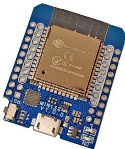
Slika 8. ESP 32 mikrokontroler (Autor slike: Arsen Ivanišević)
