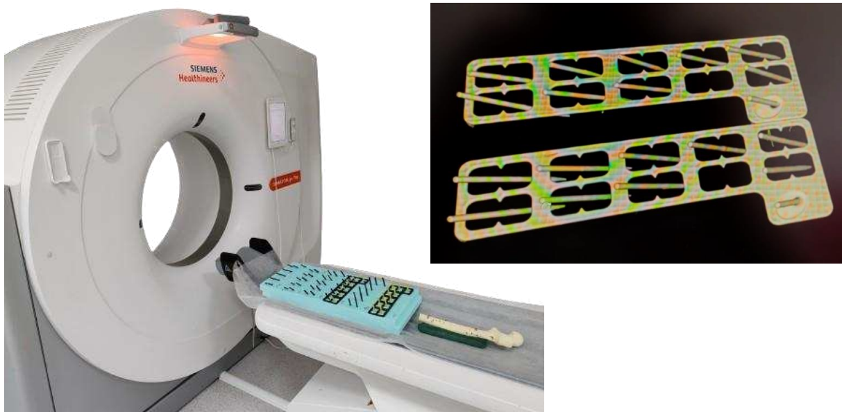
Slika 16. Procedura skeniranja kuteva bušenja s modelom 3D rekonstrukcije (Autor slike: Arsen Ivanišević)
