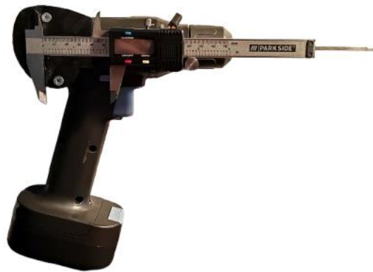
Slika 11. Digitalni Vernierov mjerac na bušilici kao inicijalno rješenje (Autor slike: Arsen Ivanišević)
