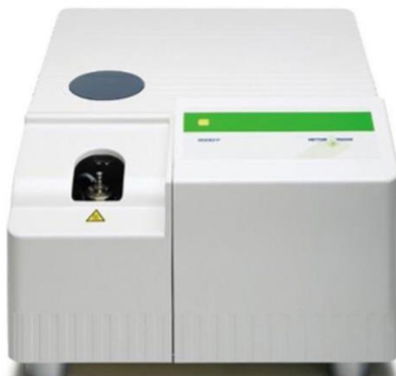
Slika 24. Diferencijalni pretražni kalorimetar Mettler Toledo DSC823 e
