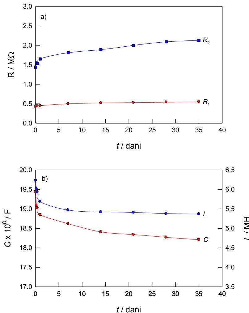
**Slika 5.3.** Vremenska promjena parametara ekvivalentnog kruga sa slike 4.1 za sustav  $\text{TiO}_2$ -mrežica /fiziološka otopina (pH 5.5) pri  $37^\circ\text{C}$
