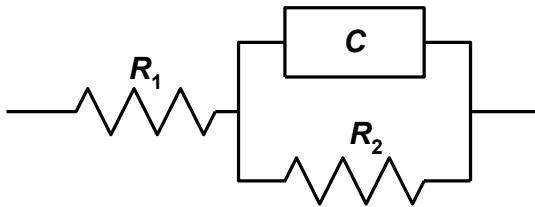
**Slika 3.7.** Električni ekvivalentni krug jednostavne elektrokemijske ćelije.
