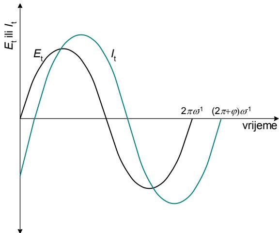
**Slika 3.5.** Sinusoidalni val za narinuti potencijal ( $E$ ) i rezultirajuću struju ( $I$ ).
