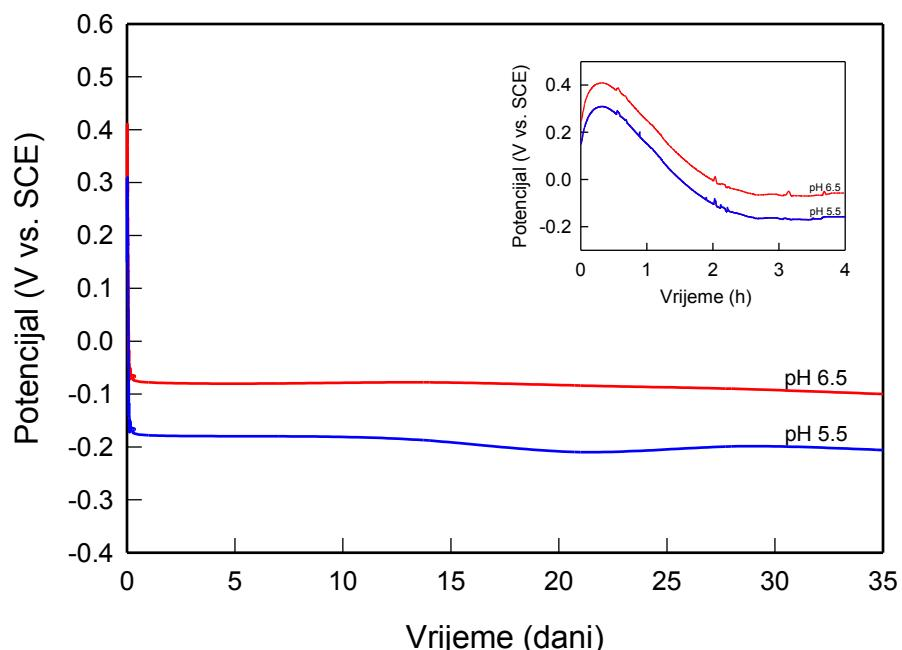
**Slika 4.1.** Vremenska promjena potencijala otvorenog strujnog kruga  $\text{TiO}_2$ -mrežice u fiziološkoj otopini različite pH vrijednosti pri 37°C
