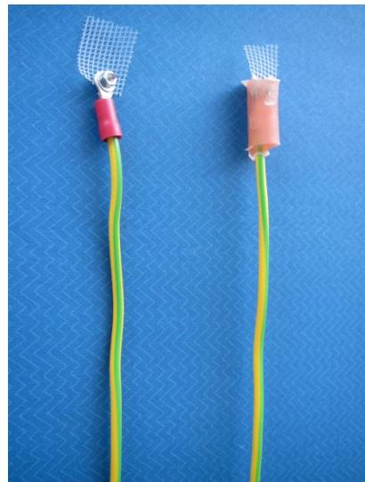
**Slika 3.3.** Kontakt na radnoj elektrodi
