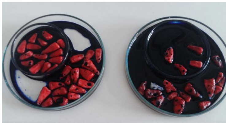
Slika 8. Prikaz uzoraka uronjenih u metilensko modrilo.
