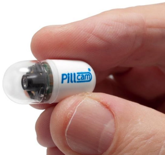
Slika 3. Endoskopska video kapsula
