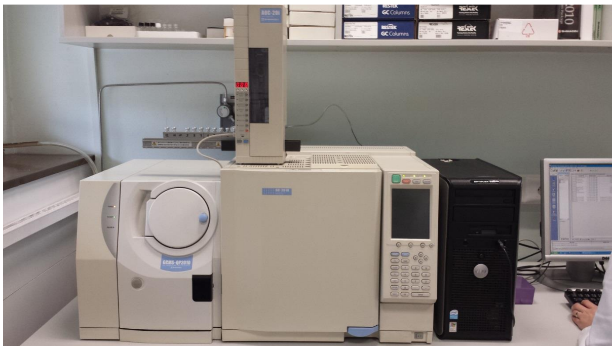
Slika 14. Plinski kromatograf sa spektrometrom masa, Shimadzu GCMS-QP2010.
