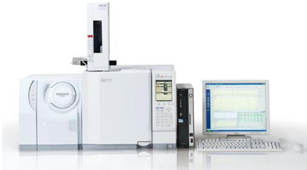
Slika 13. Plinski kromatograf sa spektrometrom masa, Shimadzu GCMS-QP2010 (65)
