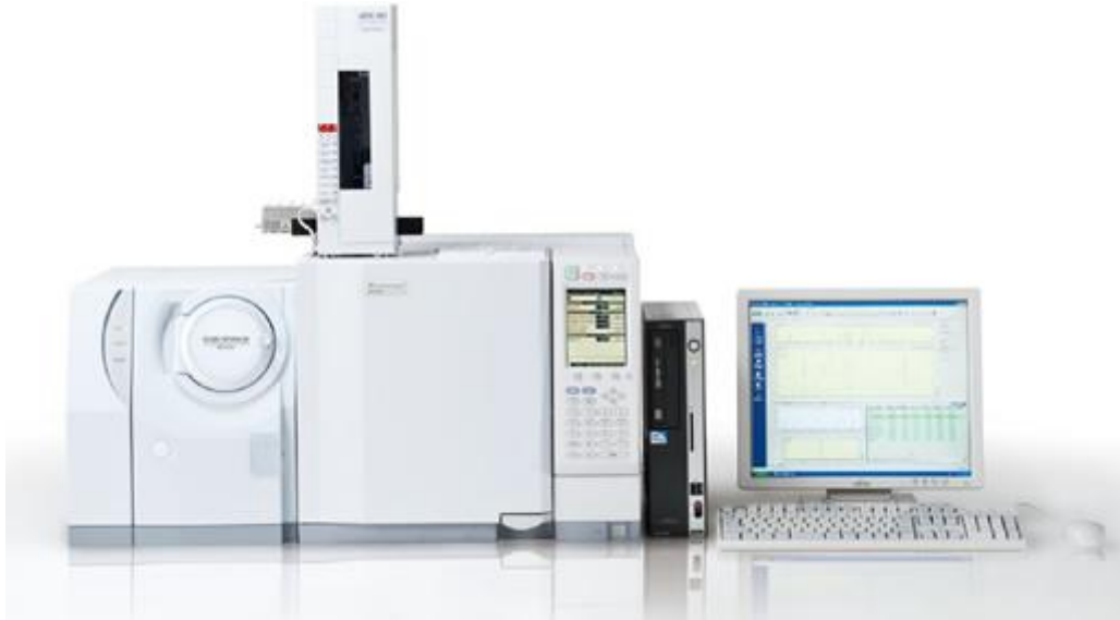
Slika 13. Plinski kromatograf sa spektrometrom masa, Shimadzu GCMS-QP2010 (65)
