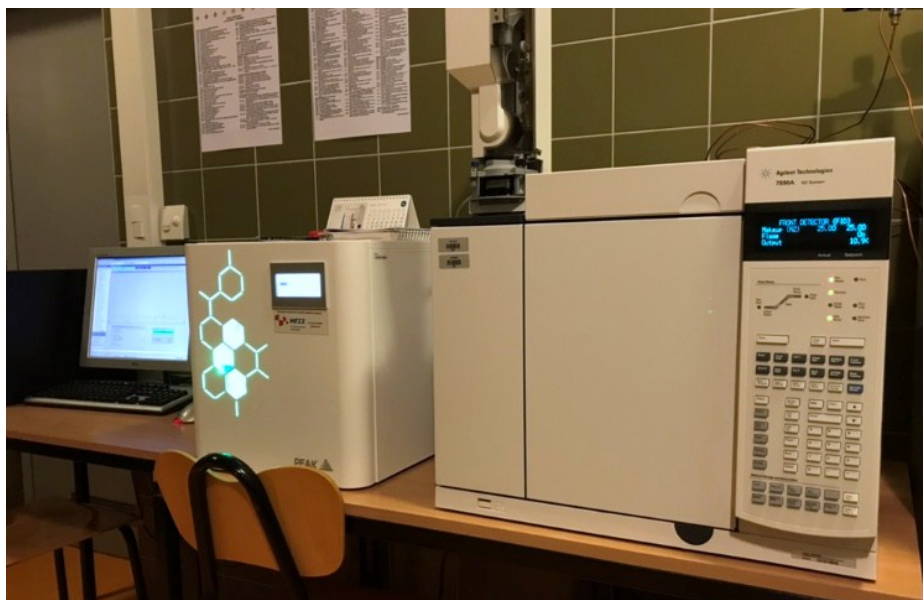
Slika 3.2. Sustav instrumenata korištenog tijekom istraživanja. Desno na slici se nalazi plinski kromatograf s automatskim uzorkivačem, lijevo se nalaze generator vodika i računalo, redom.
