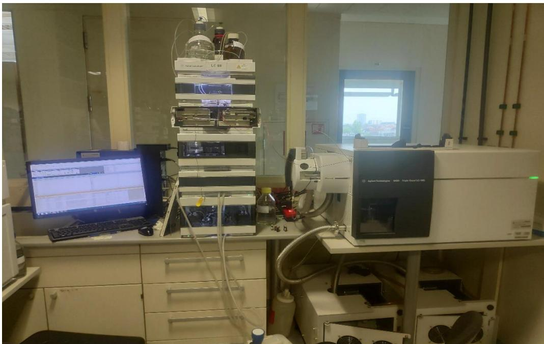
**Slika 1.5.** Uredaj za tekućinsku kromatografiju ultravisoke djelotvornosti (Agilent 1290) vezan sa spektrometrom masa s trostrukim kvadripolom (Agilent 6490)
