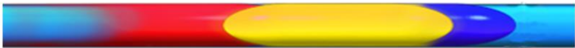
Slika 1.3. SIA: raspršenjem zone uzorka (crveno) u zonu reagensa (plavo) na njihovom sučelju nastaje produkt (žuto) [16]
