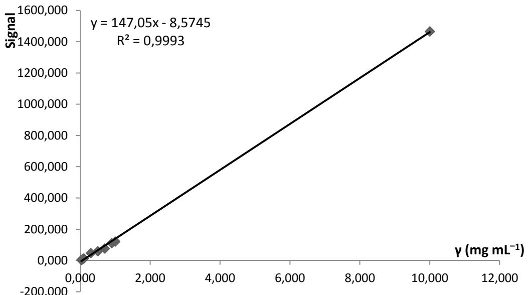
Slika 4.20. Krivulja umjeravanja za određivanje alil-izotiocijanata u rasponu masenih koncentracija od  $0,03 \text{ mg mL}^{-1}$  do  $10 \text{ mg mL}^{-1}$ .
