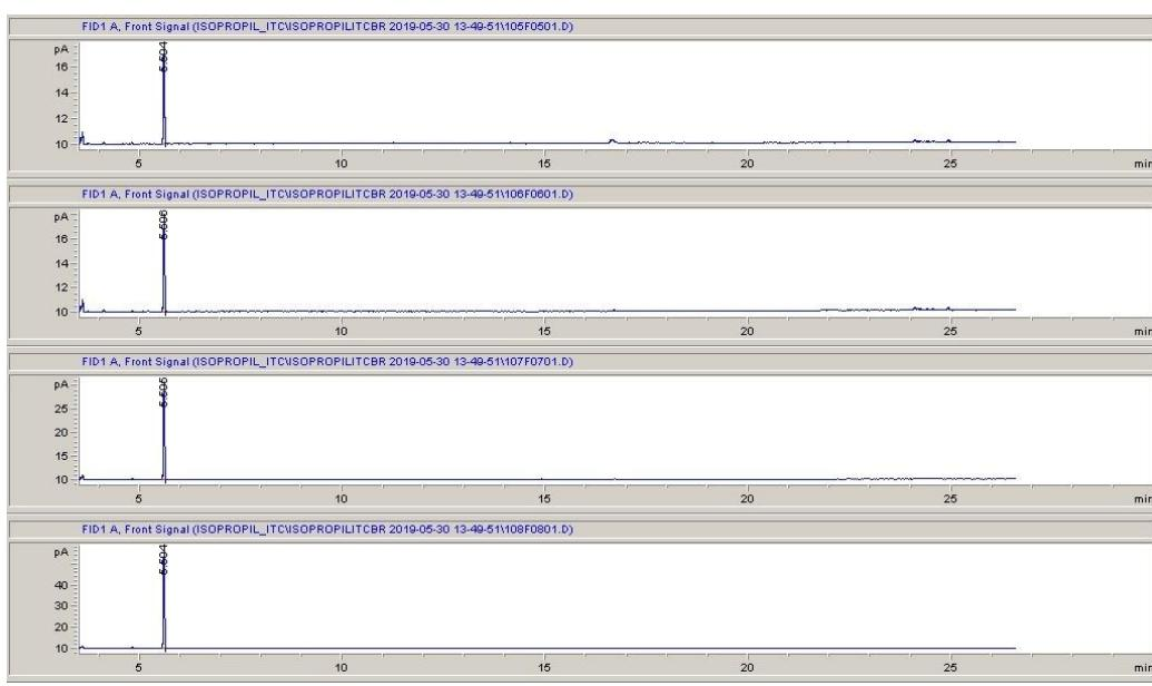
Slika 4.4. Kromatogrami standardnih otopina izopropil-izotiocijanata koncentracija  $0,09 \text{ mg mL}^{-1}$ ,  $0,10 \text{ mg mL}^{-1}$ ,  $0,30 \text{ mg mL}^{-1}$  i  $0,50 \text{ mg mL}^{-1}$ .
