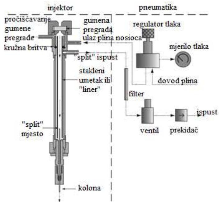
Slika 1.5. Shematski prikaz poprečnog presjeka *split/splitless* injektora (11).
