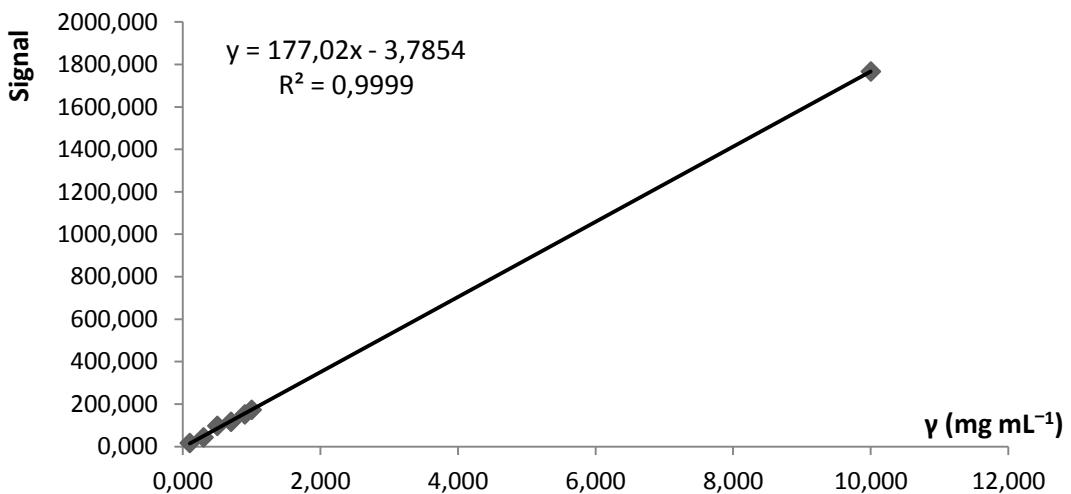
Slika 5.2. Krivulja umjeravanja za određivanje izopropil-izotiocijanata u rasponu masenih koncentracija od  $0,10 \text{ mg mL}^{-1}$  do  $10,00 \text{ mg mL}^{-1}$ .
