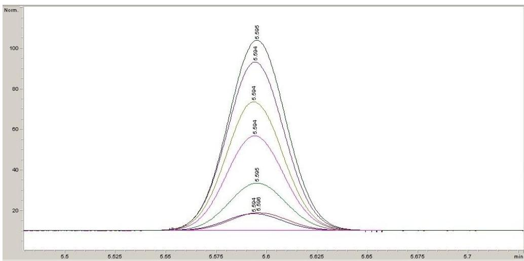
Slika 4.6. Zajednički prikaz kromatograma analiziranih standardnih otopina izopropil-izotiocijanata koncentracija  $0,09 \text{ mg mL}^{-1}$ ,  $0,10 \text{ mg mL}^{-1}$ ,  $0,30 \text{ mg mL}^{-1}$ ,  $0,50 \text{ mg mL}^{-1}$ ,  $0,70 \text{ mg mL}^{-1}$ ,  $0,90 \text{ mg mL}^{-1}$  i  $1,00 \text{ mg mL}^{-1}$ .
