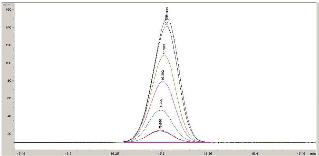
Slika 4.18. Zajednički prikaz kromatograma analiziranih standardnih otopina 2-feniletil-izotiocijanata koncentracija  $0,09 \text{ mg mL}^{-1}$ ,  $0,10 \text{ mg mL}^{-1}$ ,  $0,30 \text{ mg mL}^{-1}$ ,  $0,50 \text{ mg mL}^{-1}$ ,  $0,70 \text{ mg mL}^{-1}$ ,  $0,90 \text{ mg mL}^{-1}$  i  $1,00 \text{ mg mL}^{-1}$ .
