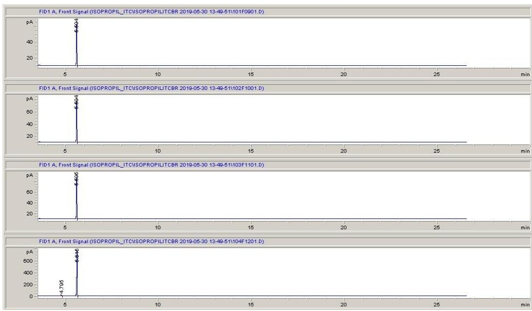
Slika 4.5. Kromatogrami standardnih otopina izopropil-izotiocijanata koncentracija  $0,70 \text{ mg mL}^{-1}$ ,  $0,90 \text{ mg mL}^{-1}$ ,  $1,00 \text{ mg mL}^{-1}$  i  $10,00 \text{ mg mL}^{-1}$ .
