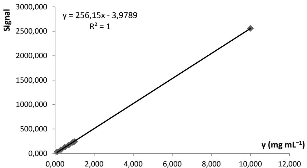
Slika 5.6. Krivulja umjeravanja za određivanje benzil-izotiocijanata u rasponu masenih koncentracija od  $0,10 \text{ mg mL}^{-1}$  do  $10,00 \text{ mg mL}^{-1}$ .
