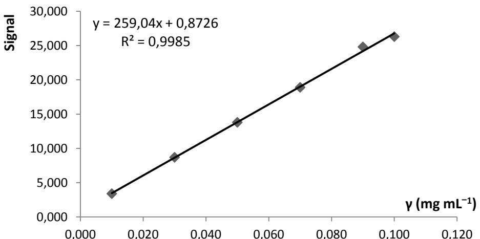
Slika 5.7. Krivulja umjeravanja za određivanje 2-feniletil-izotiocijanata u rasponu masenih koncentracija od  $0,01 \text{ mg mL}^{-1}$  do  $0,10 \text{ mg mL}^{-1}$ .
