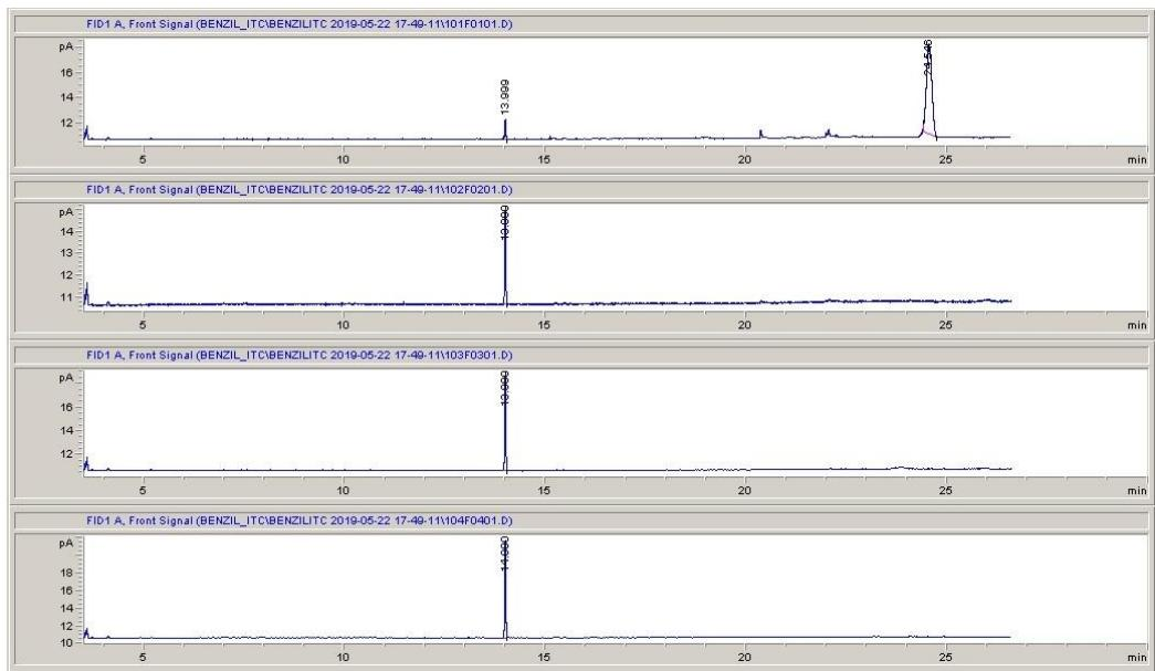
Slika 4.11. Kromatogrami standardnih otopina benzil-izotiocijanata koncentracija  $0,01 \text{ mg mL}^{-1}$ ,  $0,03 \text{ mg mL}^{-1}$ ,  $0,05 \text{ mg mL}^{-1}$  i  $0,07 \text{ mg mL}^{-1}$ .
