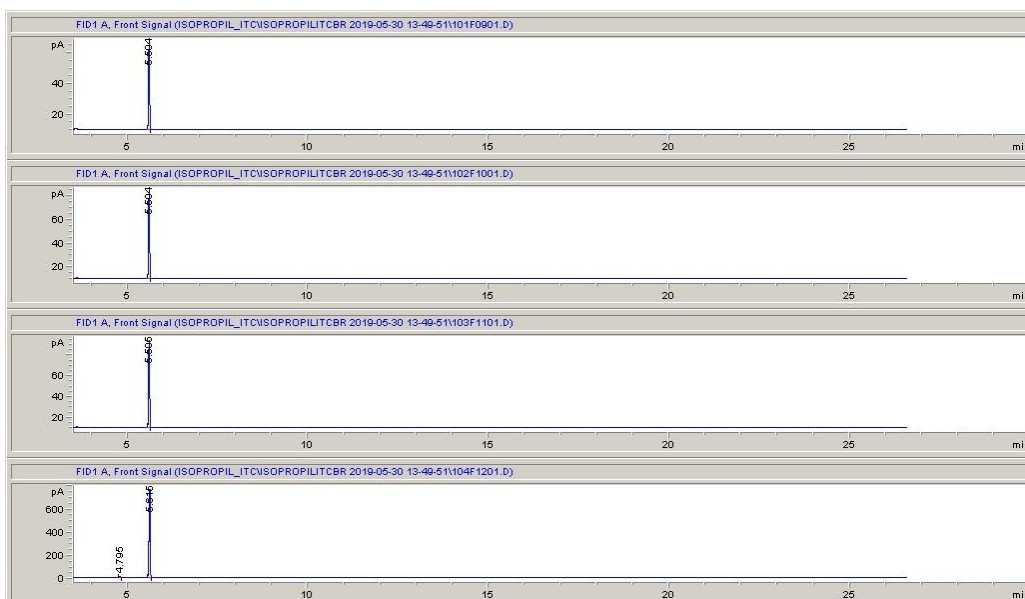
Slika 4.5. Kromatogrami standardnih otopina izopropil-izotiocijanata koncentracija 0,70 mg mL -1 , 0,90 mg mL -1 , 1,00 mg mL -1 i 10,00 mg mL -1 .
