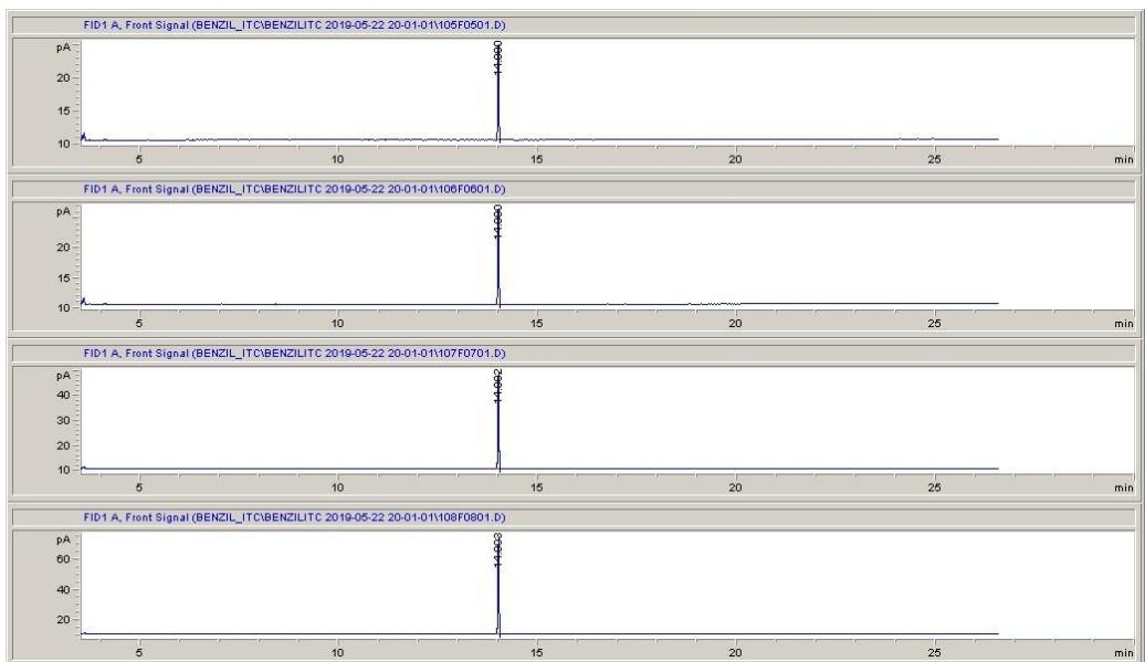
Slika 4.12. Kromatogrami standardnih otopina benzil-izotiocijanata koncentracija  $0,09 \text{ mg mL}^{-1}$ ,  $0,10 \text{ mg mL}^{-1}$ ,  $0,30 \text{ mg mL}^{-1}$  i  $0,50 \text{ mg mL}^{-1}$ .
