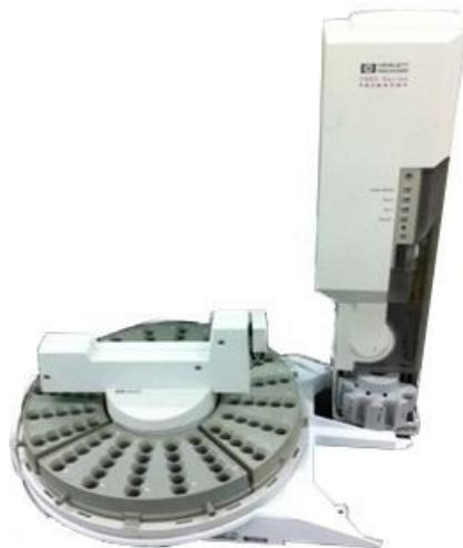
Slika 1.6. Automatski uzorkivač Agilent 7683 (14).
