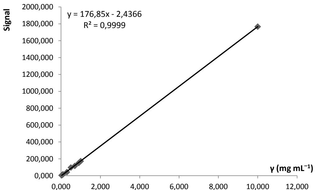
Slika 4.19. Krivulja umjeravanja za određivanje izopropil-izotiocijanata u rasponu masenih koncentracija od  $0,03 \text{ mg mL}^{-1}$  do  $10 \text{ mg mL}^{-1}$ .
