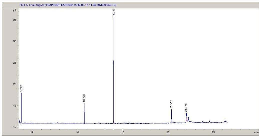
Slika 4.23. Kromatogram uzorka benzil-izotiocijanata pomiješanog s probavnim enzimima.
