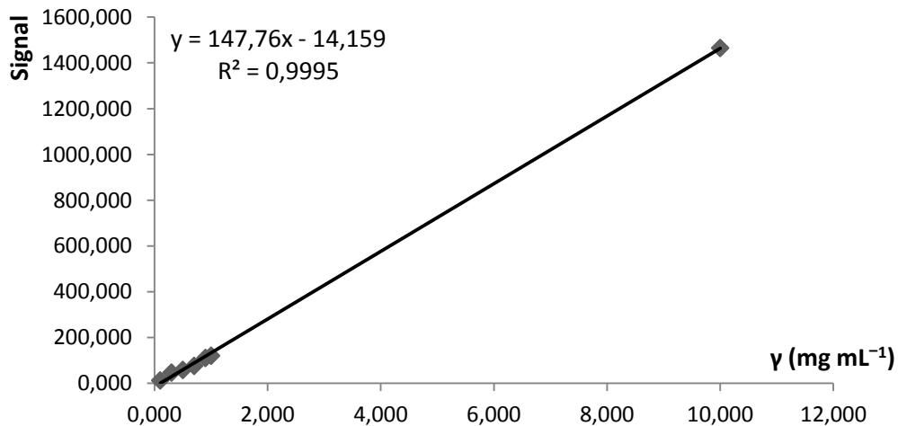
Slika 5.4. Krivulja umjeravanja za određivanje alil-izotiocijanata u rasponu masenih koncentracija od  $0,10 \text{ mg mL}^{-1}$  do  $10,00 \text{ mg mL}^{-1}$ .
