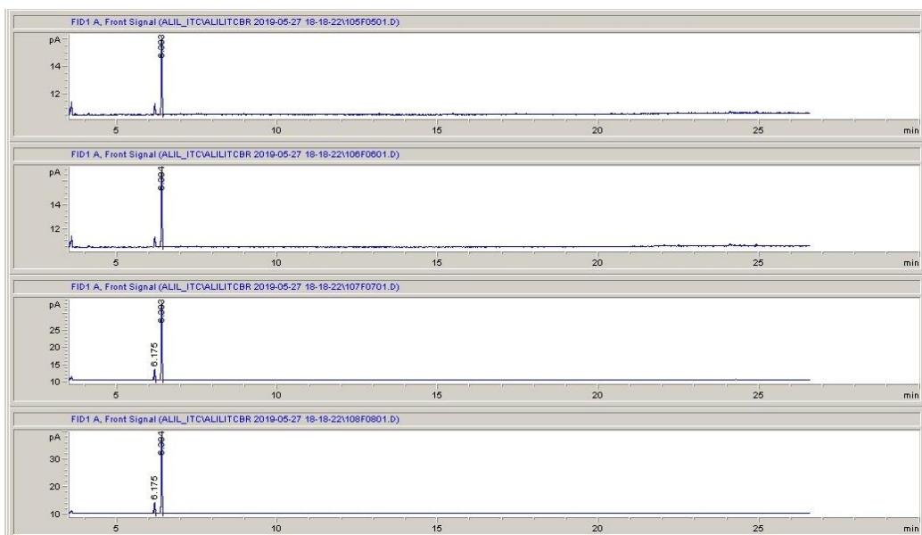
Slika 4.8. Kromatogrami standardnih otopina alil-izotiocijanata koncentracija  $0,09 \text{ mg mL}^{-1}$ ,  $0,10 \text{ mg mL}^{-1}$ ,  $0,30 \text{ mg mL}^{-1}$  i  $0,50 \text{ mg mL}^{-1}$ .
