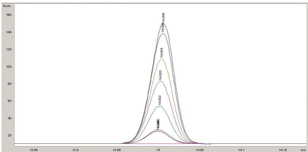
Slika 4.14. Zajednički prikaz kromatograma analiziranih standardnih otopina benzil-izotiocijanata koncentracija  $0,09 \text{ mg mL}^{-1}$ ,  $0,10 \text{ mg mL}^{-1}$ ,  $0,30 \text{ mg mL}^{-1}$ ,  $0,50 \text{ mg mL}^{-1}$ ,  $0,70 \text{ mg mL}^{-1}$ ,  $0,90 \text{ mg mL}^{-1}$  i  $1,00 \text{ mg mL}^{-1}$ .
