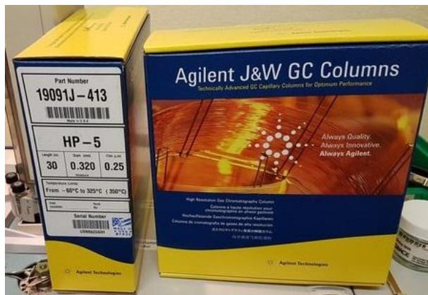
Slika 3.4. Slika korištene kapilarne kolone Agilent HP-5 19091J-413 (25).
