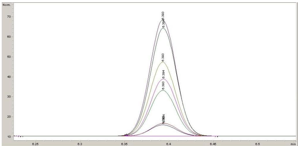
Slika 4.10. Zajednički prikaz kromatograma analiziranih standardnih otopina alil-izotiocijanata koncentracija  $0,09 \text{ mg mL}^{-1}$ ,  $0,10 \text{ mg mL}^{-1}$ ,  $0,30 \text{ mg mL}^{-1}$ ,  $0,50 \text{ mg mL}^{-1}$ ,  $0,70 \text{ mg mL}^{-1}$ ,  $0,90 \text{ mg mL}^{-1}$  i  $1,00 \text{ mg mL}^{-1}$ .
