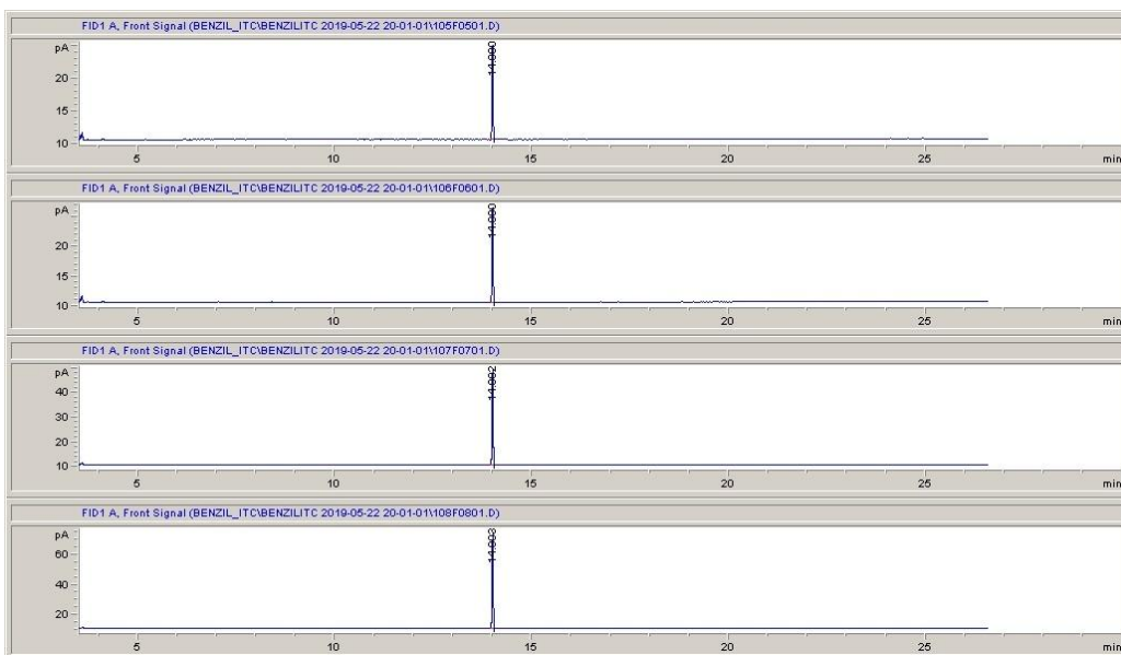
Slika 4.12. Kromatogrami standardnih otopina benzil-izotiocijanata koncentracija 0,09 mg mL -1 , 0,10 mg mL -1 , 0,30 mg mL -1 i 0,50 mg mL -1 .
