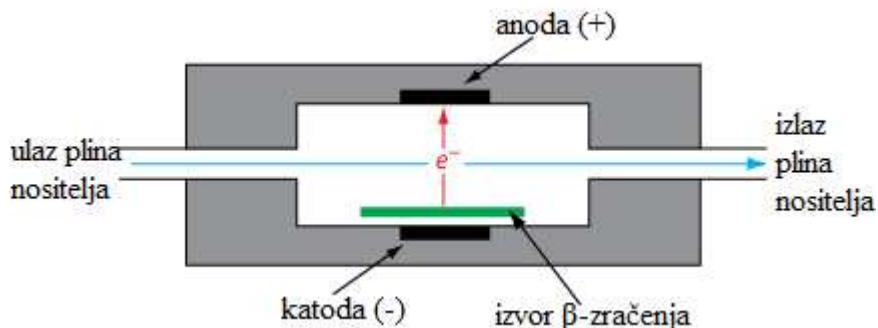
Slika 1.13. Shematski prikaz detektora apsorpcije elektrona (17).
