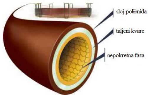
Slika 1.9. Uvećani segment WCOT kolone od taljenog kvarca.
