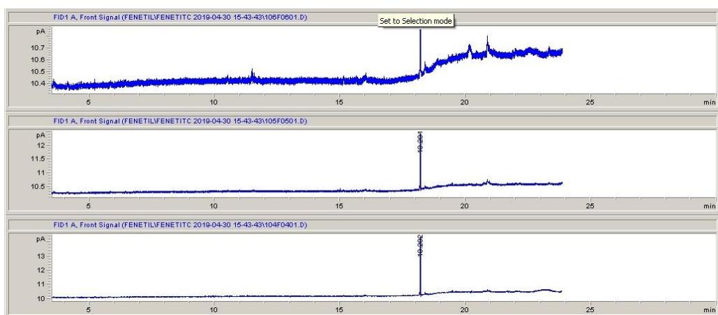
Slika 4.1. Kromatogrami standardnih otopina 2-feniletil-izotiocijanata koncentracija  $0,01\text{ mg mL}^{-1}$ ,  $0,05\text{ mg mL}^{-1}$  i  $0,10\text{ mg mL}^{-1}$ .
