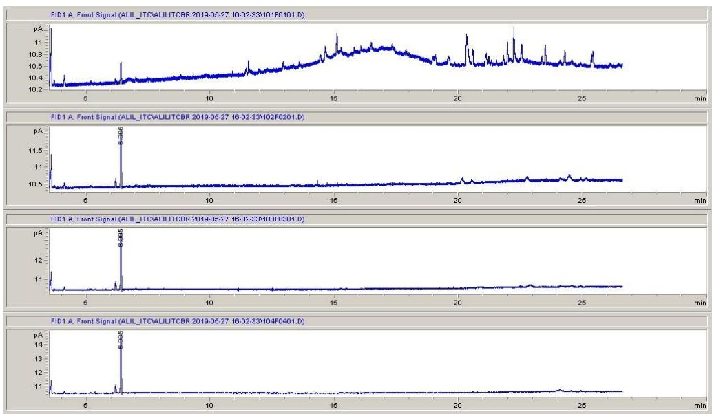
Slika 4.7. Kromatogrami standardnih otopina alil-izotiocijanata koncentracija  $0,01 \text{ mg mL}^{-1}$ ,  $0,03 \text{ mg mL}^{-1}$ ,  $0,05 \text{ mg mL}^{-1}$  i  $0,07 \text{ mg mL}^{-1}$ .
