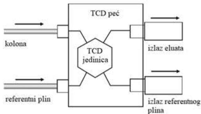
Slika 1.11. Shematski prikaz detektora toplinske vodljivosti (11).
