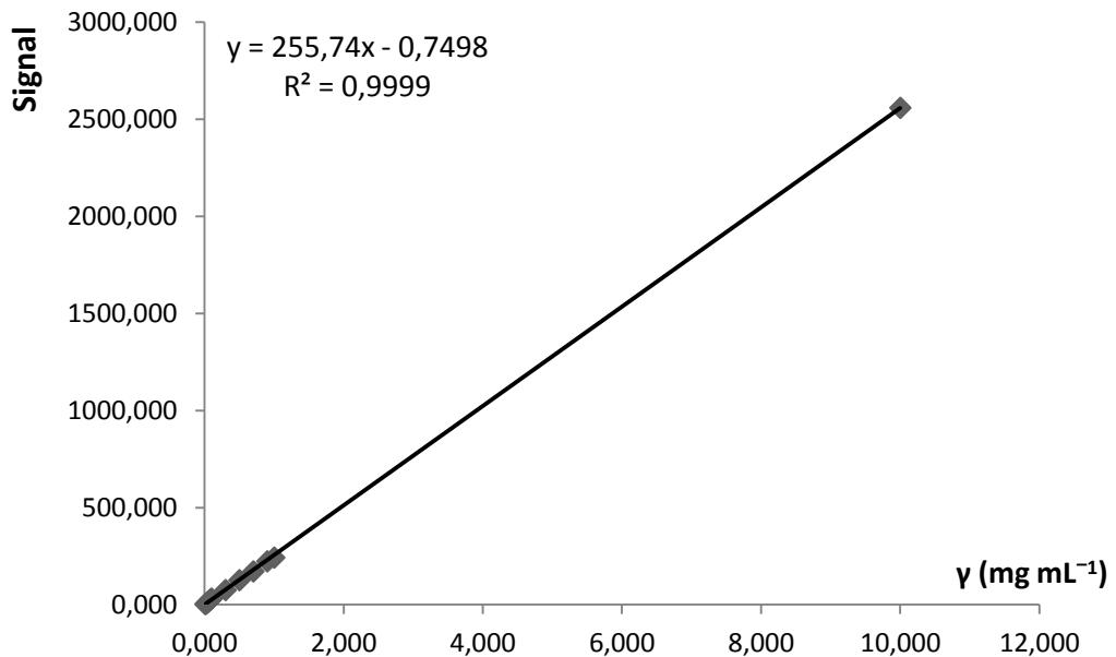
Slika 4.21. Krivulja umjeravanja za određivanje benzil-izotiocijanata u rasponu masenih koncentracija od  $0,01 \text{ mg mL}^{-1}$  do  $10 \text{ mg mL}^{-1}$ .
