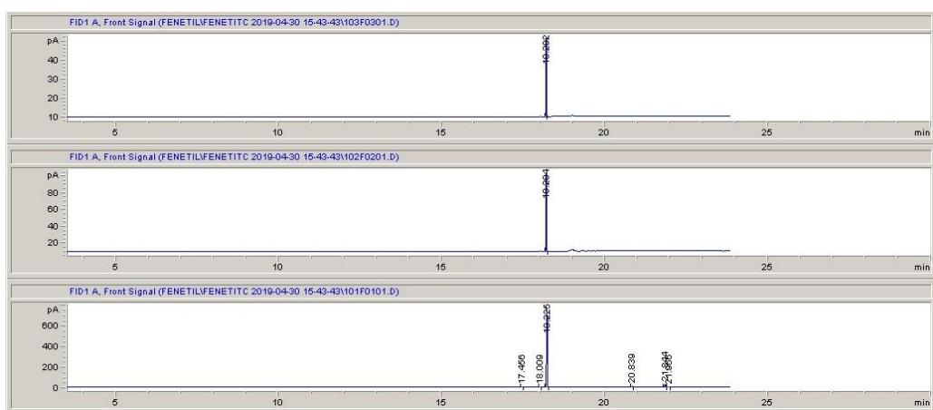
Slika 4.2. Kromatogrami standardnih otopina 2-feniletil-izotiocijanata koncentracija  $0,50\text{ mg mL}^{-1}$ ,  $1,00\text{ mg mL}^{-1}$  i  $10,00\text{ mg mL}^{-1}$ .
