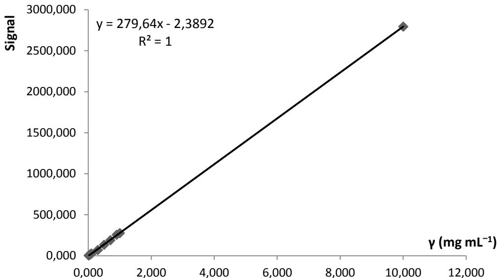
Slika 4.22. Krivulja umjeravanja za određivanje 2-feniletil-izotiocijanata u rasponu masenih koncentracija od  $0,01 \text{ mg mL}^{-1}$  do  $10 \text{ mg mL}^{-1}$ .
