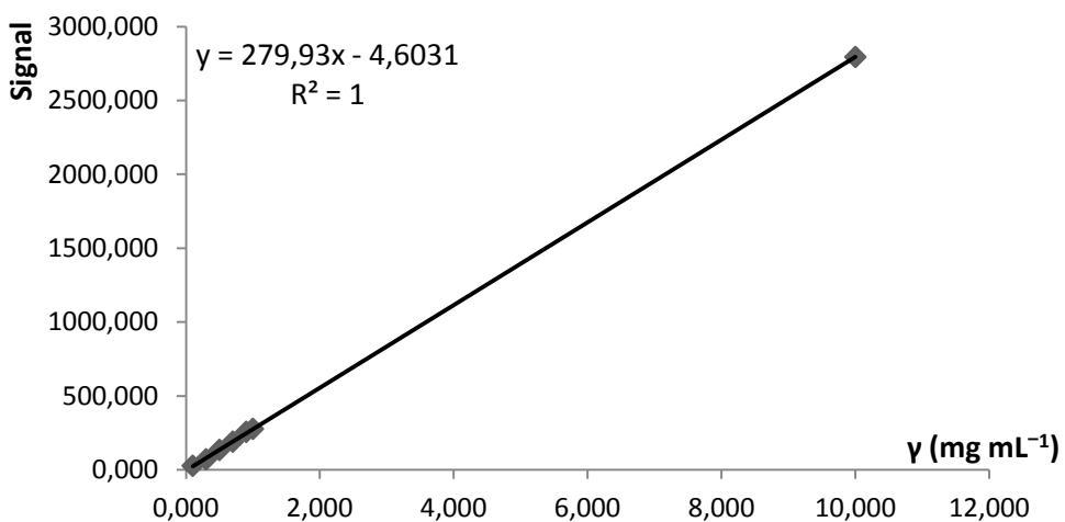
Slika 5.8. Krivulja umjeravanja za određivanje 2-feniletil-izotiocijanata u rasponu masenih koncentracija od  $0,10 \text{ mg mL}^{-1}$  do  $10,00 \text{ mg mL}^{-1}$ .
