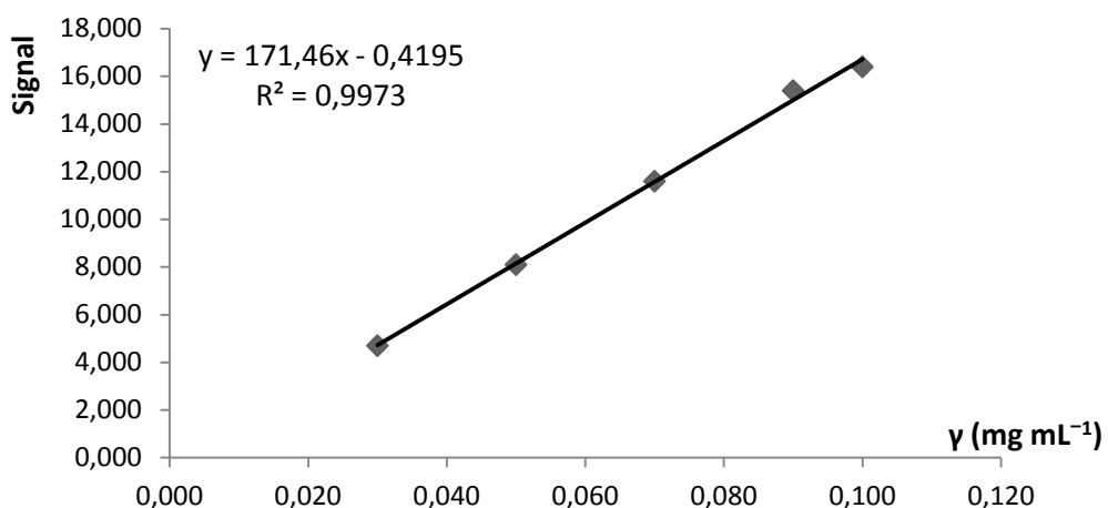
Slika 5.1. Krivulja umjeravanja za određivanje izopropil-izotiocijanata u rasponu masenih koncentracija od  $0,03 \text{ mg mL}^{-1}$  do  $0,10 \text{ mg mL}^{-1}$ .
