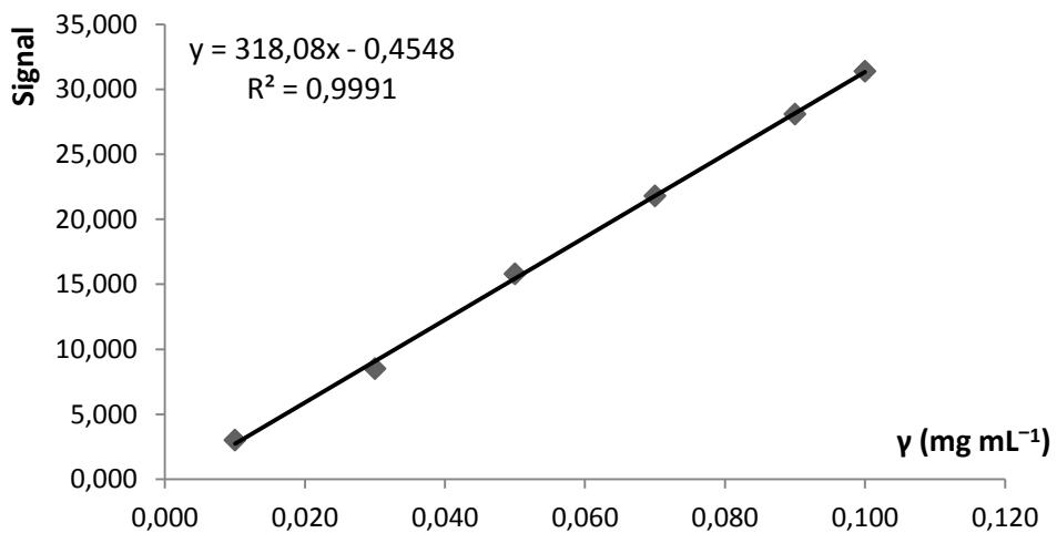
Slika 5.5. Krivulja umjeravanja za određivanje benzil-izotiocijanata u rasponu masenih koncentracija od  $0,01 \text{ mg mL}^{-1}$  do  $0,10 \text{ mg mL}^{-1}$ .
