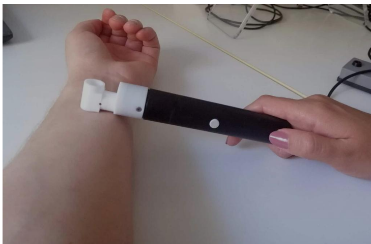
Slika 9. Mjerenje TEWL vrijednosti pomoću sonde Tewameter
