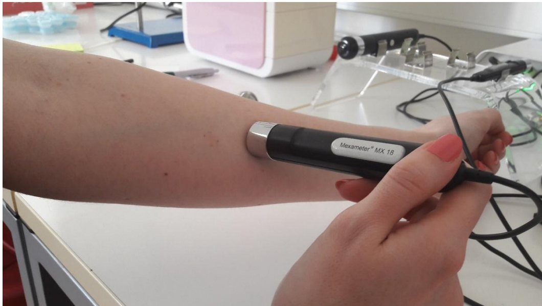
Slika 8. Mjerenje eritema i melanina korištenjem Mexameter MX18 sonde
