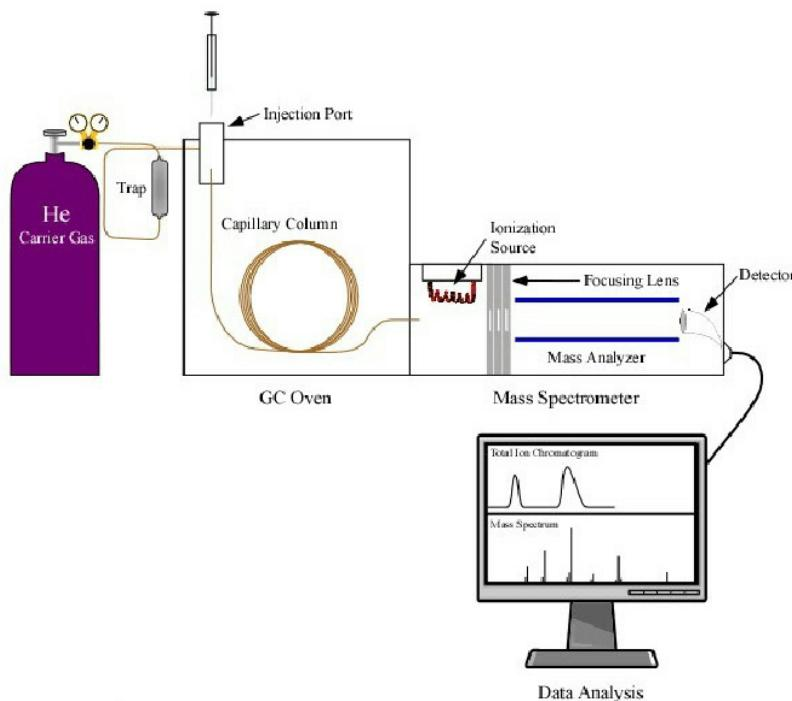
**Slika 4.** Shematski prikaz osnovnih dijelova GC-MS tehnike (67)
