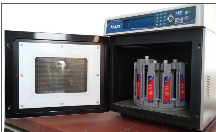
Slika 3. Mikrovalna peč za digestiju uzoraka CEM Mars 5
