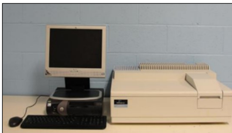
Slika 2. UV-Vis spektrofotometar Perkin Elmer Lambda 25, double beam
