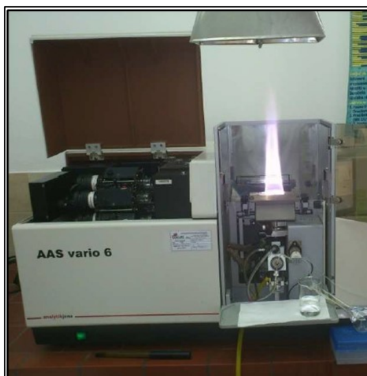
Slika 1. Slika korištenog instrumenta, AAS vario 6
