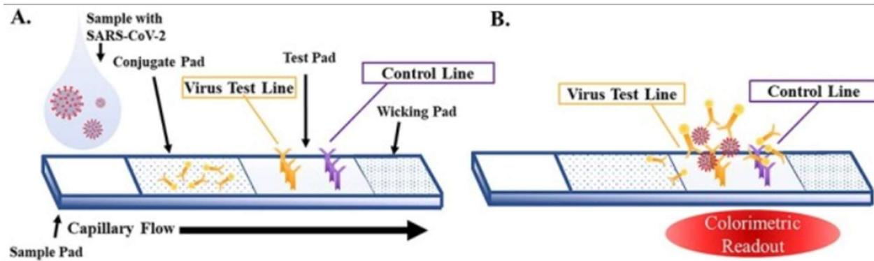
**Slika 1.** Shematski prikaz LFIA testiranja na SARS-CoV-2, izvor: <https://www.ncbi.nlm.nih.gov/pmc/articles/PMC8194834/bin/gzab010f2.jpg>
