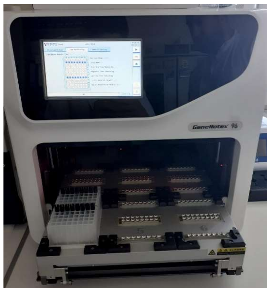
Slika 6. Uređaj GeneRotex 96 s ubačenim uzorcima za izolaciju u Laboratoriju za molekularnu dijagnostiku NZJZ – SDŽ
