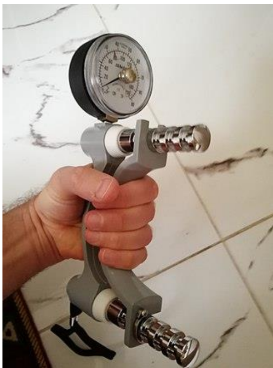
Slika 14. Upotreba dinamometra za mjerenje mišićne snage. Preuzeto sa Wikipedia (2024), dostupno na https://en.wikipedia.org/wiki/Dynamometer , prema licenci CC BY 4.0.
