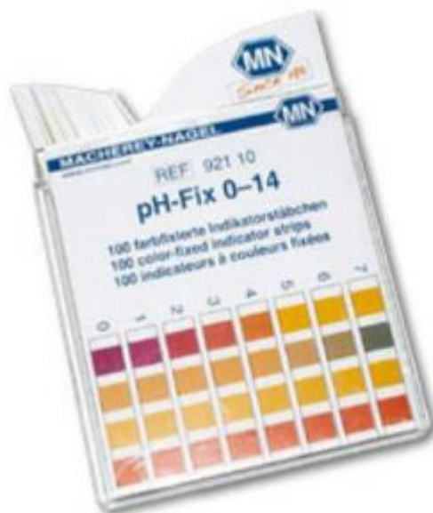
Slika 1. Papirnati indikatori sa pH skalom u boji. Preuzeto i obrađeno s: http://www.mn-net.com/tabid/11154/default.aspx
