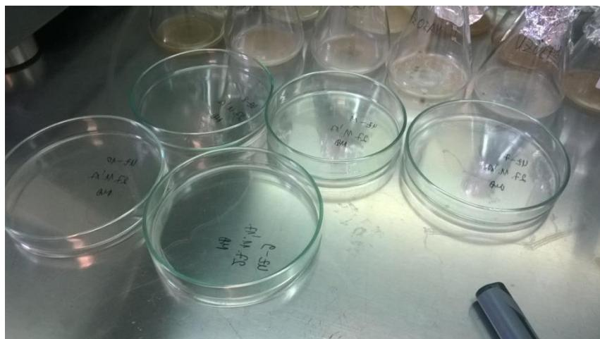
Slika 6. Evaporacija uzoraka u digestoru do suha
