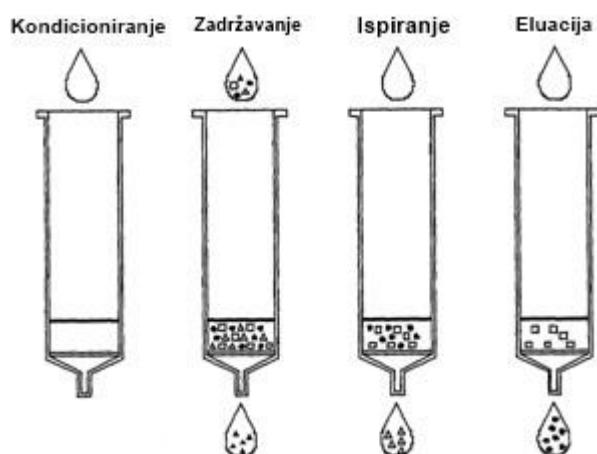
**Slika 4.** Priprema uzorka metodom ekstrakcije čvrstom fazom (SPE) (40)
