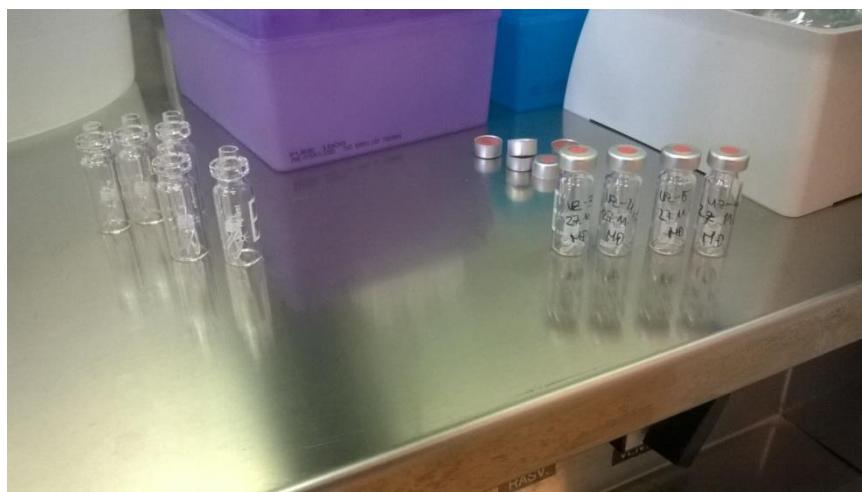
Slika 7. Tubice uzoraka za GC/MS analizu
