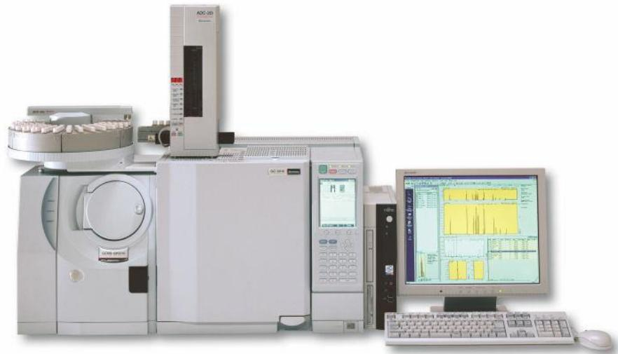
**Slika 8.** Plinski kromatograf sa spektrometrom masa; Shimadzu GCMS-QP2010 (46)
