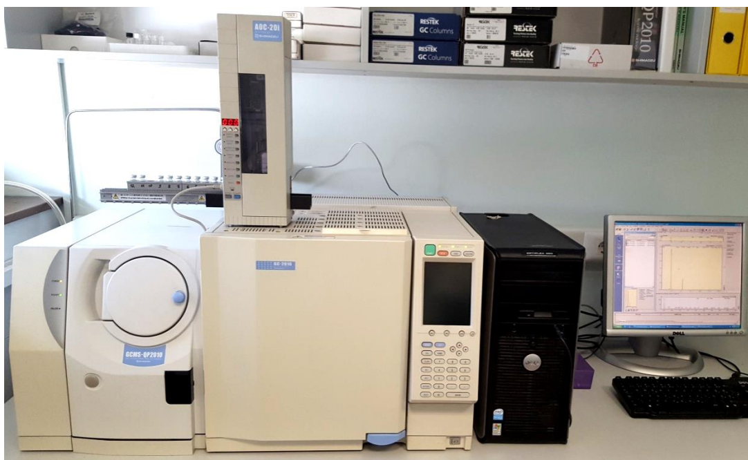
Slika 8. Plinski kromatograf sa spektrometrom masa; Shimadzu GCMS-QP2010
