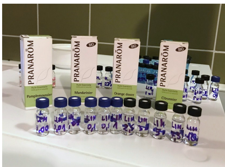
Slika 3.1. Slika korištenih Pranarom eteričnih ulja te pripremljenih standardnih otopina limonena
