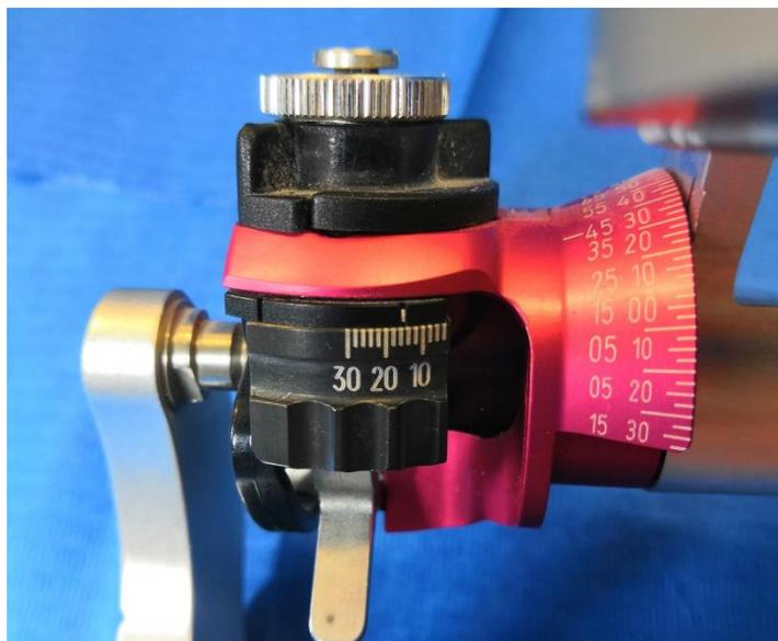
**Slika 6.** Dio artikulatora za namještanje Bennettovog kuta.
