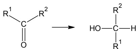
Slika 11. Redukcija ketona u sekundarni alkohol (19).
