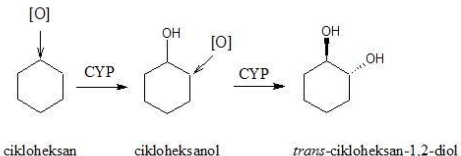
Slika 9. Mehanizam hidroksilacije C-atoma u prstenastom sustavu. (19)
