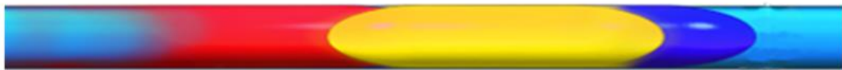
Slika 1.3. SIA: raspršenjem zone uzorka (crveno) u zonu reagensu (plavo) na njihovom sučelju nastaje produkt (žuto) [16]
