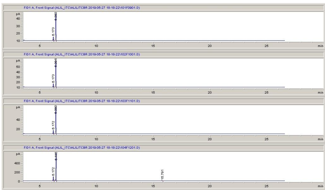
Slika 4.9. Kromatogrami standardnih otopina alil-izotiocijanata koncentracija 0,70 \text{ mg mL}^{-1} , 0,90 \text{ mg mL}^{-1} , 1,00 \text{ mg mL}^{-1} i 10,00 \text{ mg mL}^{-1} .
