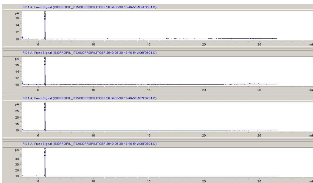
Slika 4.4. Kromatogrami standardnih otopina izopropil-izotiocijanata koncentracija 0,09 mg mL -1 , 0,10 mg mL -1 , 0,30 mg mL -1 i 0,50 mg mL -1 .
