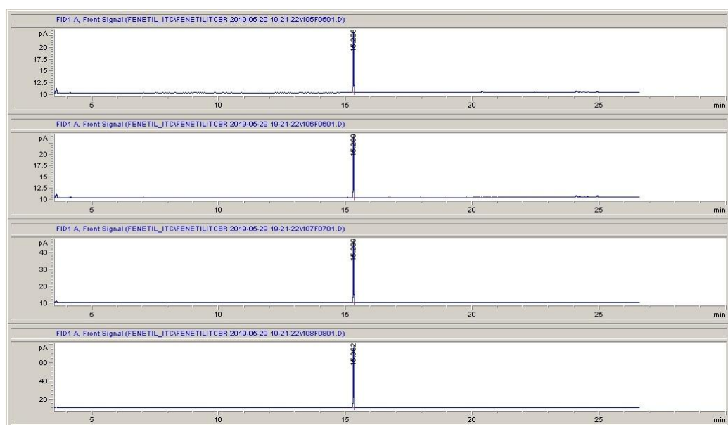
Slika 4.16. Kromatogrami standardnih otopina 2-feniletil-izotiocijanata koncentracija 0,09 \text{ mg mL}^{-1} , 0,10 \text{ mg mL}^{-1} , 0,30 \text{ mg mL}^{-1} i 0,50 \text{ mg mL}^{-1} .
