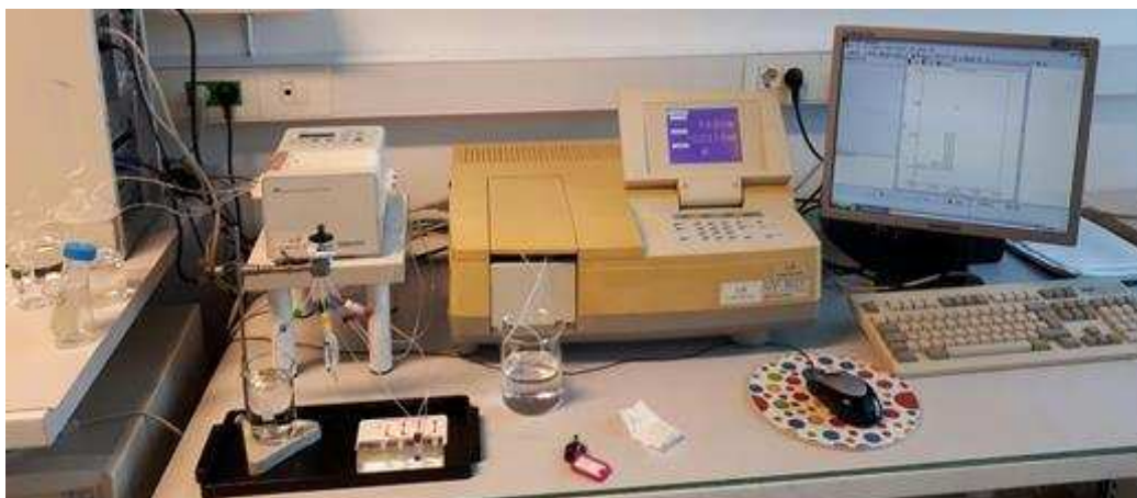
Slika 3.17. Prikaz mjerne instrumentacije za određivanje N -acetil-L-cisteina kinetičkom spektrofotometrijskom metodom
