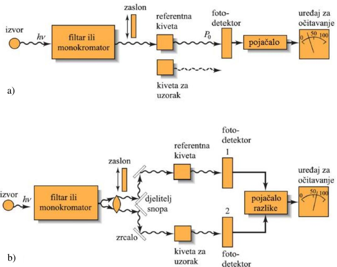
Slika 3.16. Shematski prikaz spektrofotometra: a) jednosnopni; b) dvosnopni [29]
