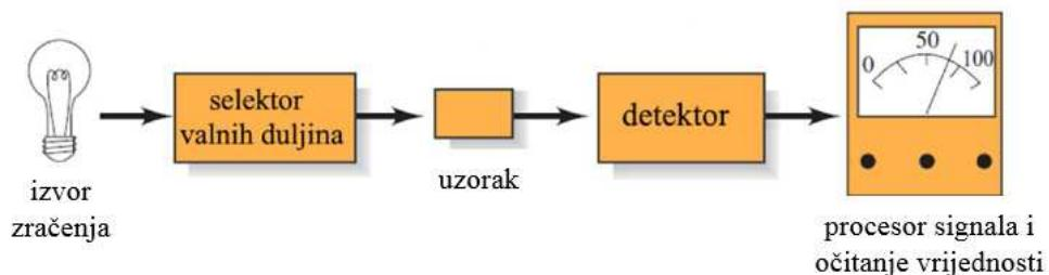
Slika 3.15. Instrumentacija za apsorpcijska mjerjenja [29]
