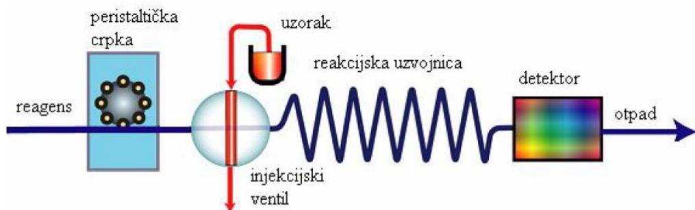
Slika 3.2. Shema jednokanalnog FIA sustava [19]
