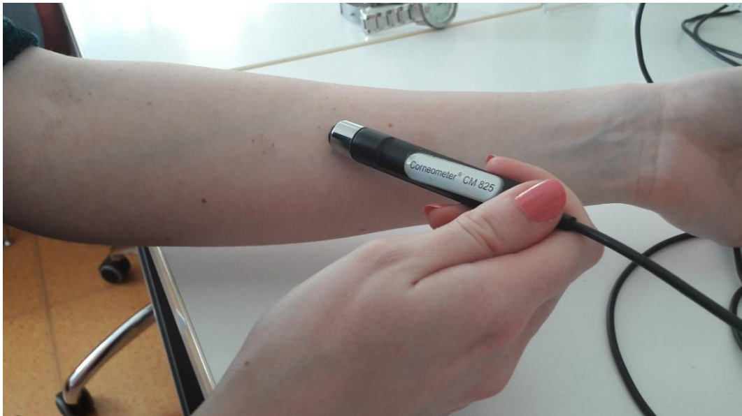
Slika 7. Mjerenje vlažnosti kože korištenjem Corneometer CM825 sonde
