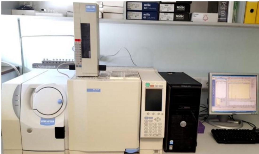
Slika 11. Uređaj GC-MS s povezanim računalom.
