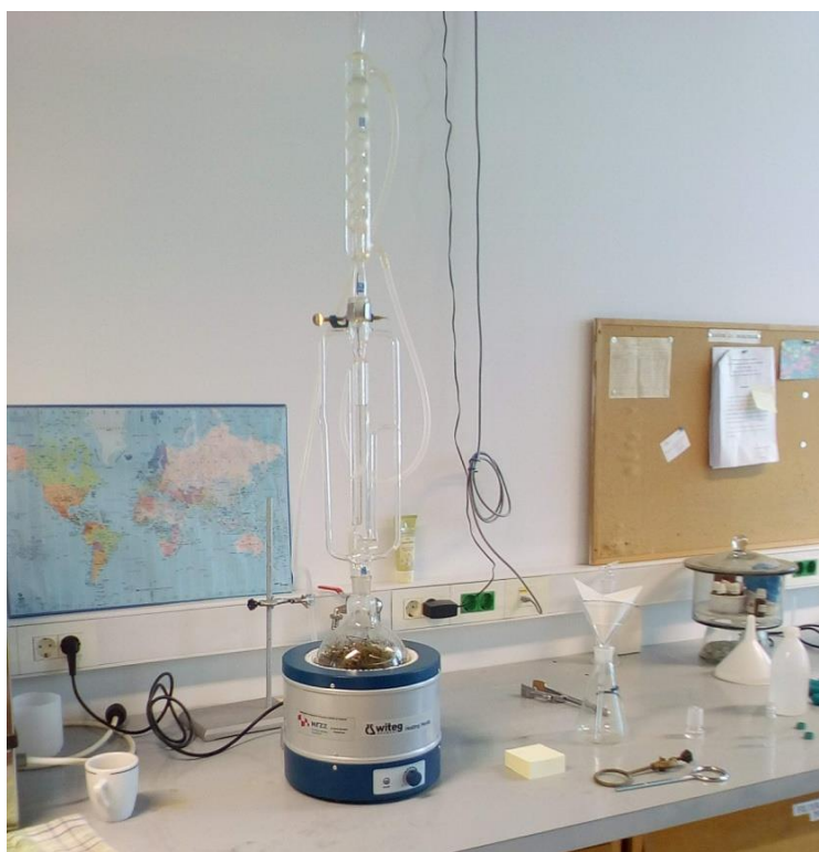
Slika 11. Hidrodestilacija uzorka, aparatura po Clevengeru
