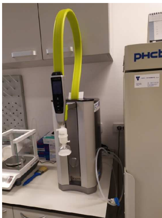
Slika 2. Uređaj za pročišćavanje vode (Purelab Flex 3 (18.2 MΩ, UV 185/254 nm, TOC <5 ppb, Tip 1), Elga)
