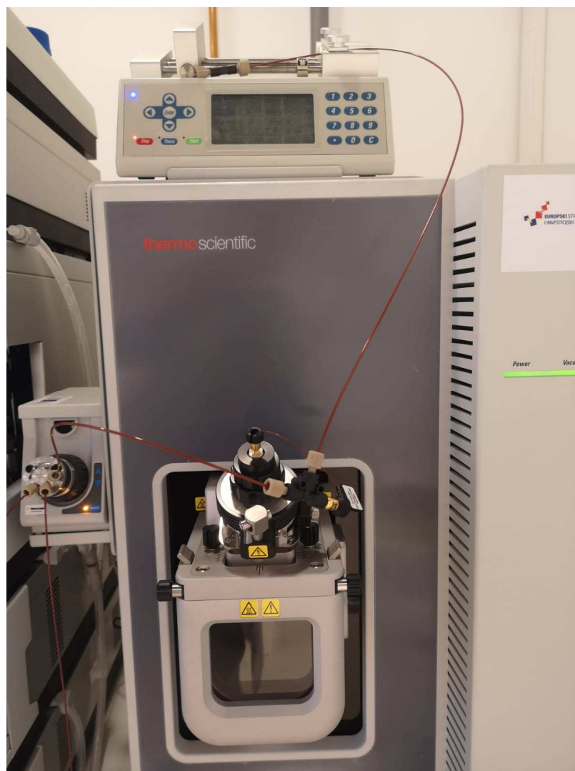
Slika 3.5. Pumpa sa špricom spojena sa tekućinskim kromatografom i spektrometrom masa s trostrukim kvadrupolom pomoću T-spoja za optimizaciju parametara masenog spektrometra
