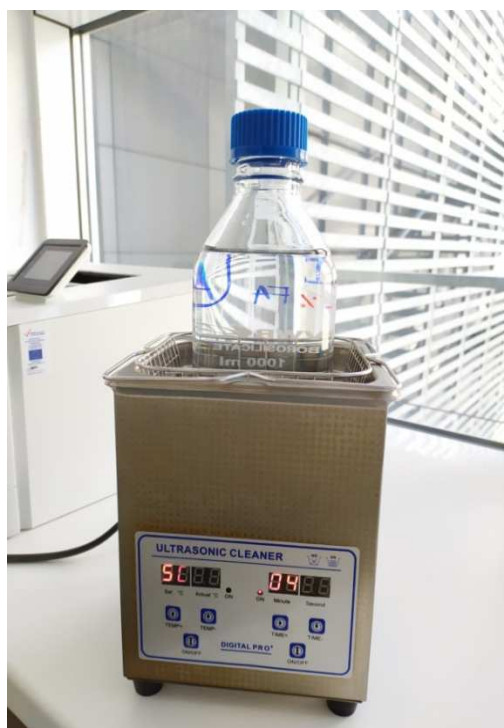
Slika 3. Ultrazvučna kupelj (JP-010, Digital Pro)
