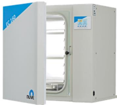
Slika 18. Prikaz vlažnog inkubatora, koji služi za uzgoj stanica (Preuzeto s: http://www.nuve.com.tr/Products/Incubation/ec-160-co2 )
