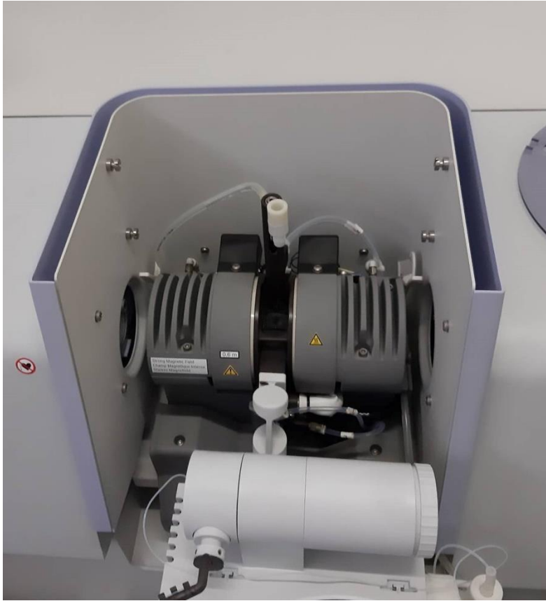
Slika 3.8. Grafitna peć unutar koje se nalazi grafitna kiveta
