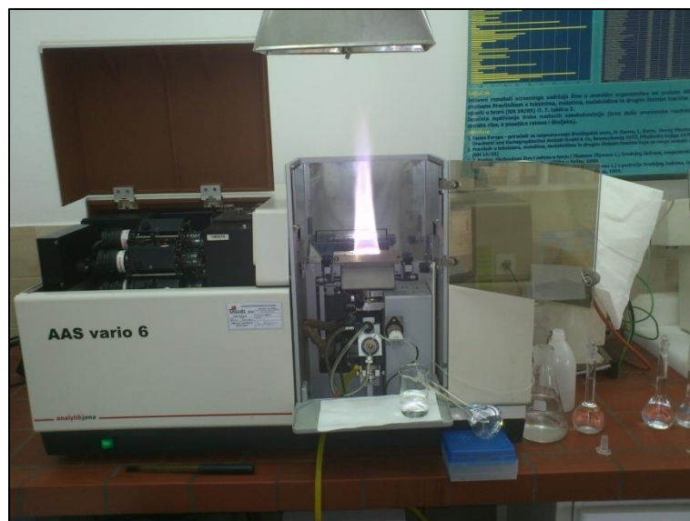
Slika 7. Atomski apsorpcijski spektrofotometar AAS Vario 6, Analytik Jena. (Izvor: Privatna arhiva)
