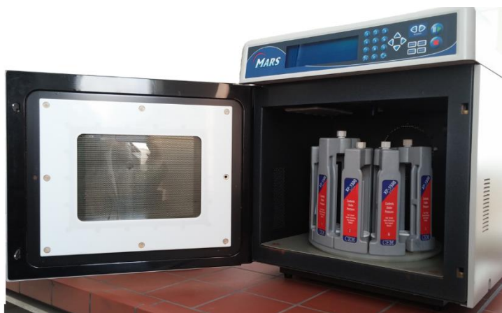
Slika 4. Mikrovalna peć za digestiju uzoraka CEM Mars 5, sa setom teflonskih posuda za razaranje uzoraka (Izvor: Privatna arhiva)
